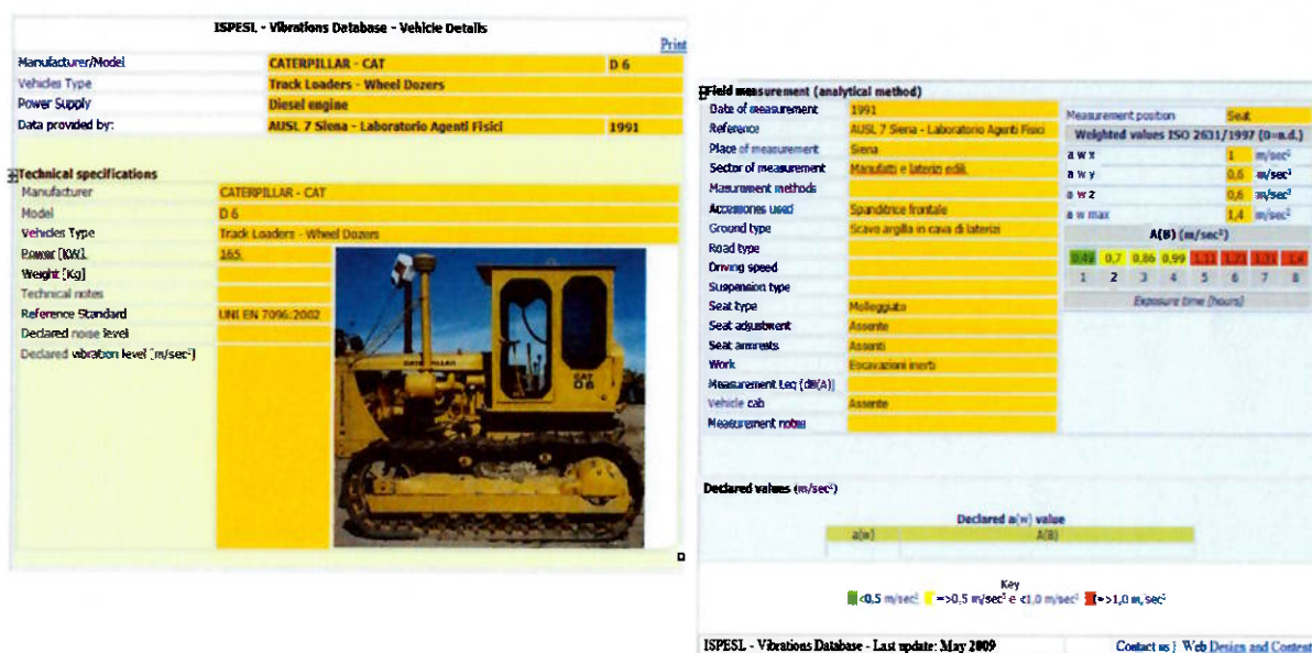
Figura 6 – Dados de vibração e características do Trator de Esteira Modelo Caterpillar D6T
